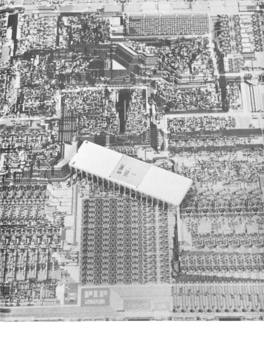
Chip di un microcomputer. Questo chip contiene molti più circuiti di un chip di un microprocessore. Infatti, oltre a contenere i circuiti richiesti per effettuare le funzioni di controllo e per le operazioni aritmetico-logiche presenti in un microprocessore, incorpora anche la memoria di programma e dei dati da elaborare.
